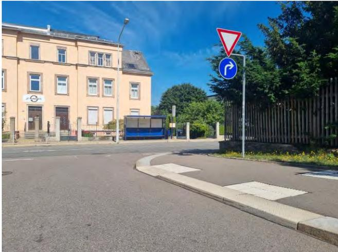
Foto: Beispiel einer vollständig barrierefreien Gestaltung der einer Fußgängerquerung
